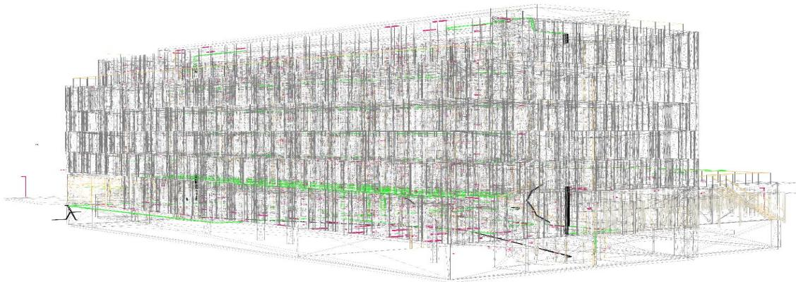
**Figur. 1** Byggnaden Smaragden; arkitektonisk, elektrisk, mekanisk och strukturell modell (perspektiv från sydöst mot nordväst). Producerad med Autodesk NAVISWORKS 2019. © Felix Peniche.
