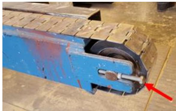
Figur 6-5. Stropparna riskerar att fastna i bulten på rullbordet och dras loss från väggelementet när elementet rullas vidare längs med tillverkningslinjen.
