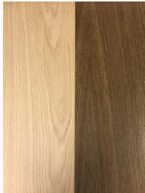
Två fanerade ekbitar från samma virke, en före och en efter ammoniakrökning.
