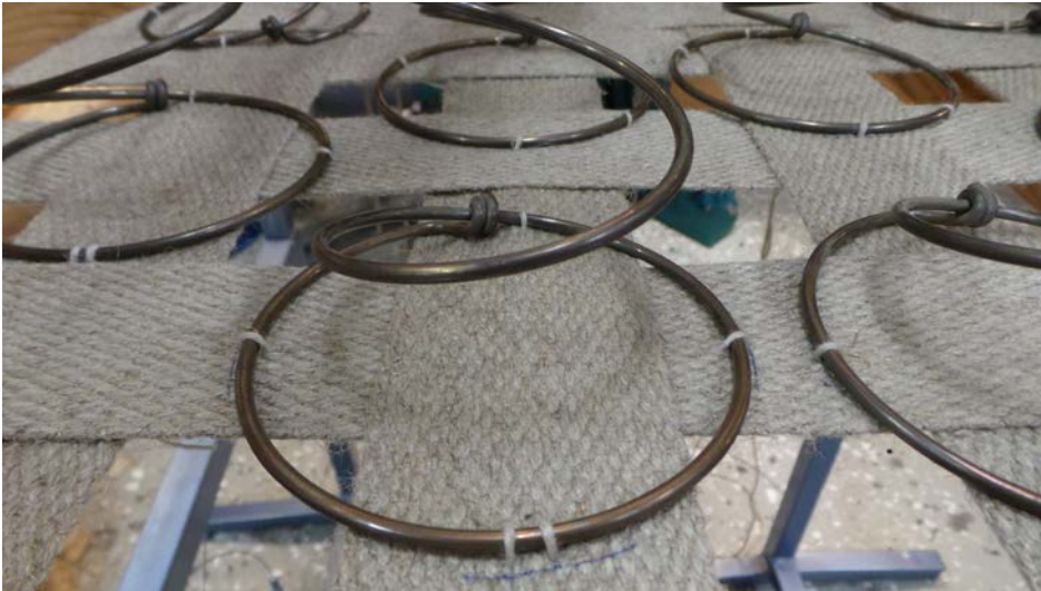
Bilden visar hur stygnen som håller fast resårerna ser ut från ovasidan.
